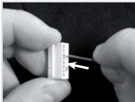
3. Insérer la borne dans le support pour rail DIN.
