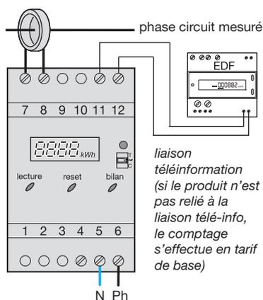
**Exemple de branchement avec un compteur électromécanique. Mesure des circuits de chauffage.**
