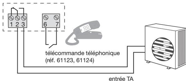
Raccordement d'un circulateur de chauffage ou de climatisation
