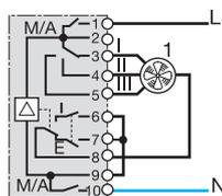
Régulation de la ventilation (1) à la vitesse sélectionnée
