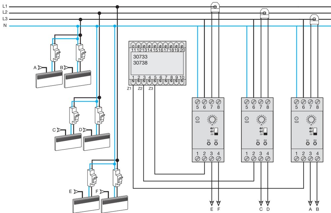
Délestage 6 voies d'un chauffage électrique à fil pilote sur réseau triphasé.
