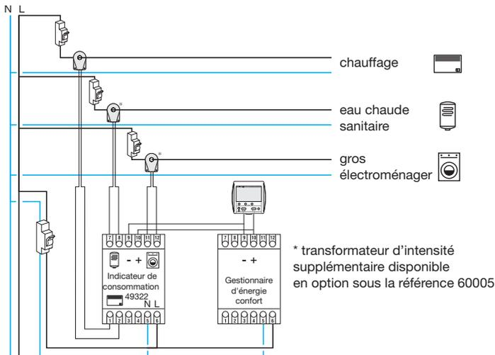
**Exemple de branchement avec un compteur électronique. Mesure des circuits de chauffage.**
