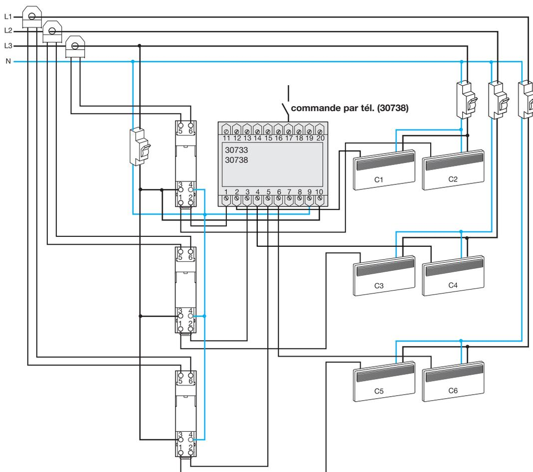
**Programmation et délestage par fil pilote d'une installation en triphasé.**
