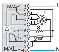
En hiver, régulation sur le contacteur de chauffage (3), en été, sur la vanne d'admission d'eau glacée (2)
