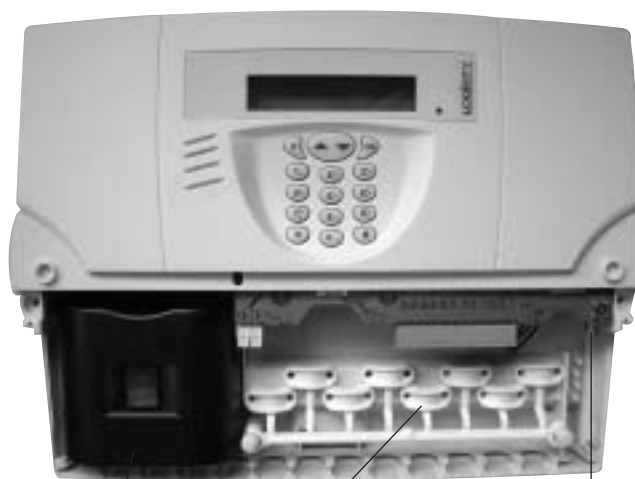
Vue intérieure transmetteurs G450-30X et G470-30X
